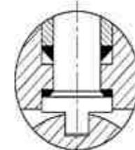
固定式(金属密封)球阀座采用高弹性、高压缩率的材料为后辅助密封,以补偿温度变化引起的胀缩。
